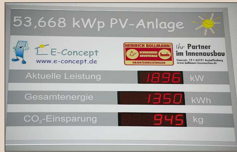
Die digitale Schautafel im Eingangsbereich zeigt den genauen Stand an: In den letzten sechs Wochen wurden insgesamt 1350 Kilowattstunden Strom erzeugt und der Umwelt wurden 945 Kilo Kohlendioxid erspart. Foto: Petra Kriechel
